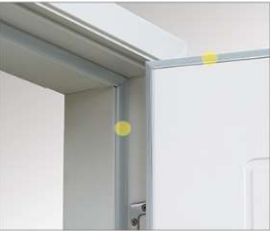
45° 静音胶条 45度软磁吸密封条，模拟冰箱门磁吸原理，使门的吸附力与密封性更好，降低了声音在两者之间的传递，从而提高了隔音效果。改变以往硬性的木质材料的碰撞，以及中间缝隙的无填充。
